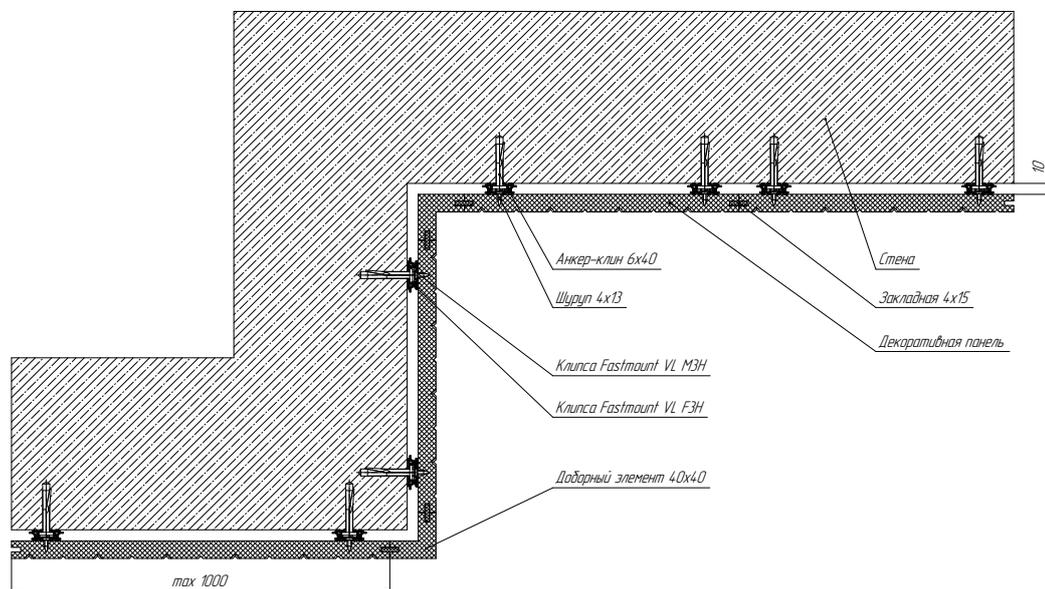
Скрытая система крепления на клипсы с возможностью легко демонтировать и смонтировать заново панели на те же клипсы.
