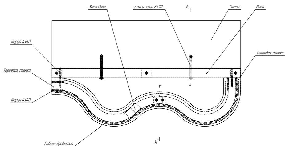
Система крепления для гибкого дерева на изогнутые направляющие. Шаг направляющих по вертикали от 1-го до 2-х метров.
